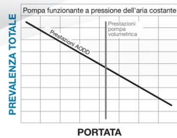
Benché la pompa AODD sia di tipo volumetrico, in realtà è un ibrido e sfugge a una rigorosa classificazione. Anche se le sue caratteristiche di pressione rispetto alla capacità assomigliano a quelle di una pompa centrifuga, è meglio definirla come una pompa non (o semi) volumetrica, senza sistema di tenuta.
