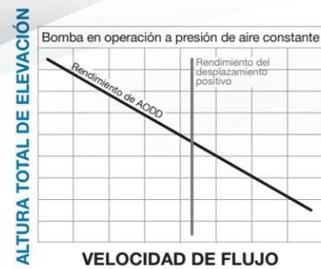
Aunque la bomba AODD es un tipo de bomba de desplazamiento positivo, en realidad, es un modelo híbrido que desafía las clasificaciones estrictas. Si bien sus características de presión versus capacidad se asemejan a las de una bomba centrífuga, se define mejor como una bomba sin desplazamiento positivo o con desplazamiento semipositivo, sin sello.
